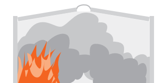
Inne mat. budowlane: często silne wydzielanie się dymu
