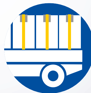
Po zakończeniu załadunku kierowca powinien zabezpieczyć towar przed przemieszczaniem za pomocą pasów i narożników
